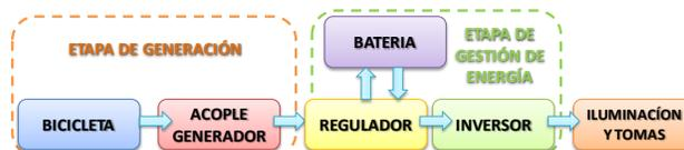
Figura 2. Esquema general del subsistema aislado.
