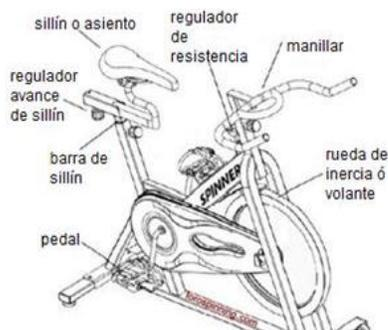
Figura 3. Partes de una bicicleta estática [2].
