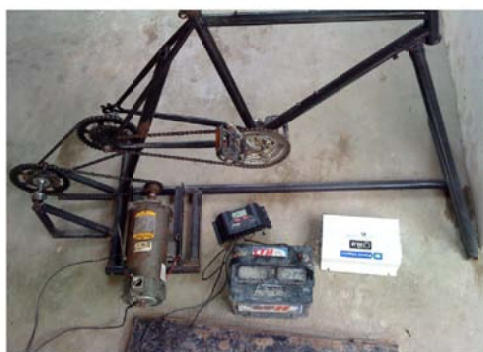
Figura 2. En esta imagen se muestran la instrumentación utilizada para cargar la batería y para convertir la corriente directa en corriente alterna.
