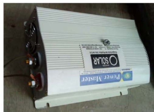
Figura 5. En esta imagen tenemos al inversor, encargado de convertir la corriente directa de la batería, en corriente continua que es la de utilización doméstica.
