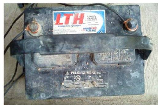
Figura 4. En esta imagen se observa la batería que se conectó al controlador, para que se encargara de almacenar la energía en corriente directa generada por el prototipo.
