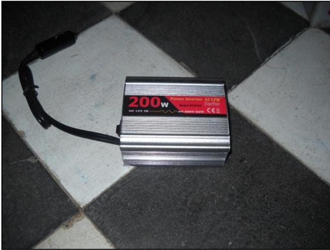
Es un inversor de 200 [W] de potencia, calculo que la duración de esta potencia respecto a la batería que tengo, que es de 100[A], es de alrededor de 5 horas, descontando el margen de error de un 10% aprox.
