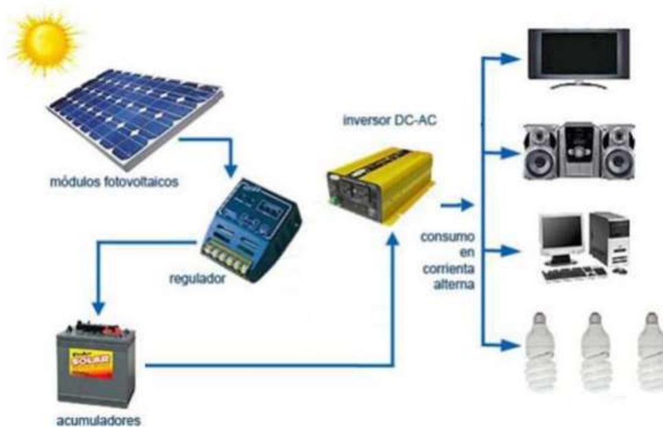
Figura 2. Componentes del sistema
