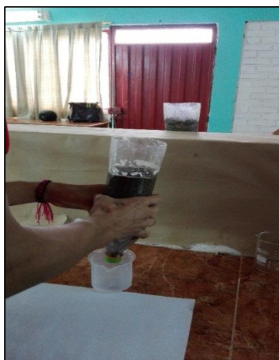
Ilustración 10. Elaboración de filtro de arena
