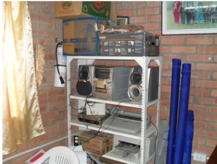
Recomendaciones: se recomienda señalizar y demarcar el extintor como se muestra en la figura y no colocarlos a una altura mayor a 1.50 m del suelo. Y colocarlo en un lugar visible y de fácil acceso libre de obstáculos.
