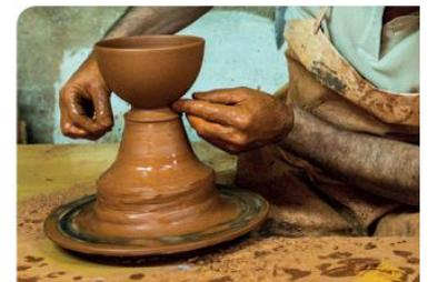
1 El torno se usa para fabricar piezas de cerámica. Consiste básicamente en una rueda que gira sobre un eje.
