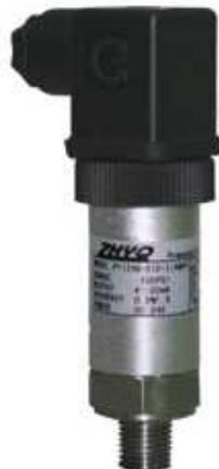
Al sensor de presión se le realizó una caracterización de la señal, utilizando un manómetro calibrado y sometiéndolo a diferentes valores de presión de aire para analizar la señal de salida del sensor. Para esto se utilizó una resistencia de  $255 \Omega$  y un amplificador operacional MCP601 conectado como un seguidor de tensión (*Buffer*) para obtener el valor de la tensión en la resistencia y así conocer la corriente que circula por el sensor dependiendo de la presión del medio.
